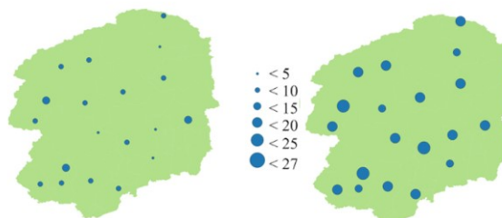
Fig.2 1/10年確率年最大1時間降水量の2K上昇実験と4K上昇実験の変化
